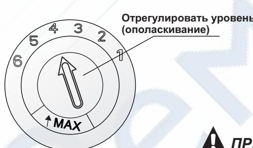
Устройство распределения ополаскивающего средства имеет шесть или четыре позиции настройки. Начинайте настройку устройства с положения 4. При образовании пятен и плохом высыхании посуды увеличьте количество подаваемого ополаскивателя, сняв крышку резервуара, установите переключатель на следующую ступень. Так поступайте до прекращения образования пятен. Рекомендуемая настройка - "4". (Заводская установка по умолчанию - "4".)
